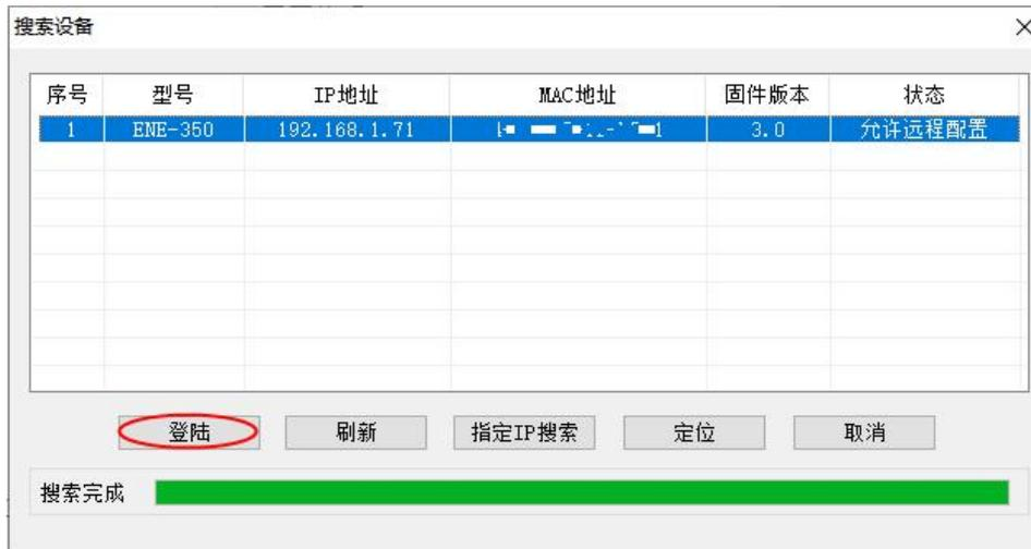
点击“登陆”进入“上载配置”窗口，点击“上载”按钮，一段时间后上载完成。
