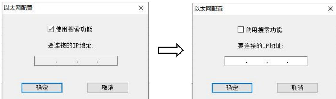
输入正确 IP 地址后，软件会搜索网络中具有这个 IP 地址的 ENE-350 设备。
