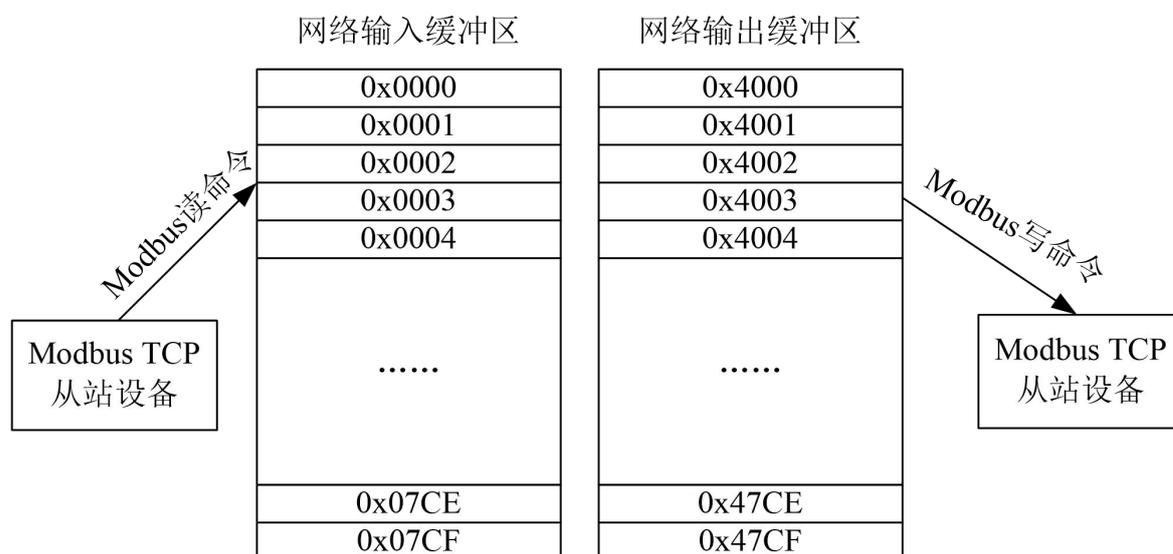
如上图所示：网络输入缓冲区范围 0x0000 ~ 0x07CF（支持功能码 01、02、03、04、23，作为数据输入；支持功能码 05、06、15、16、23，作为本地数据交换）；网络输出缓冲区范围 0x4000 ~ 0x47CF（支持功能码 05、06、15、16、23，作为数据输出）。
