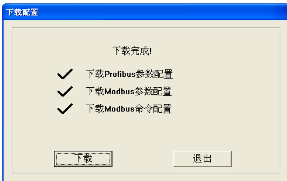
备注 1: 在下载配置之前, 请先检查“串口配置”中端口号是否为正在使用的串口。
